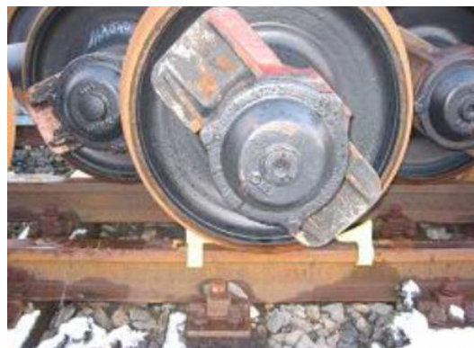
Obr.2 Uložení na koleji prostřednictvím bezpečnostních klínů
