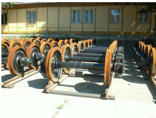
Obr.1 Uložení na koleji prostřednictvím bezpečnostních klínů
