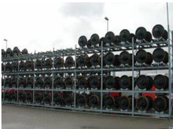
Obr 5.Uložení na plošinách (stohované uložení)
