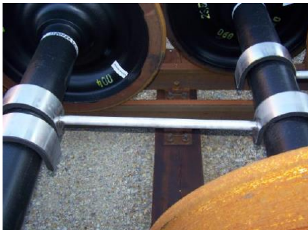
Obr. 7 Uložení na dvojitě koleji prostřednictvím vymezovacích držáků
