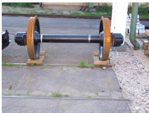
Obr 6.Uložení na podložkách (jednotlivá dvojkolí)
