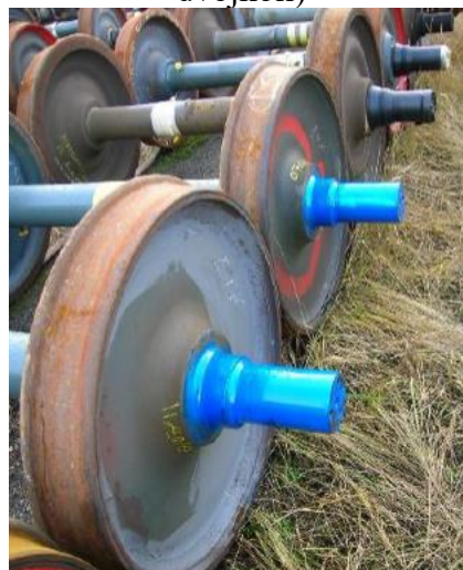
Obr. 8 Uložení dvojkolí bez ložisek (ochranný nástřik na čepech)
