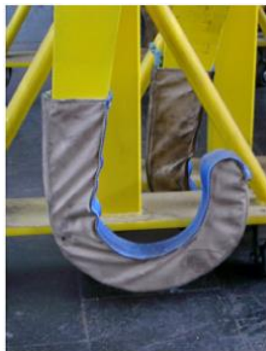
Obr. 2 Jeřábový nástavec pro dvojkolí – odnímatelná ochrana
